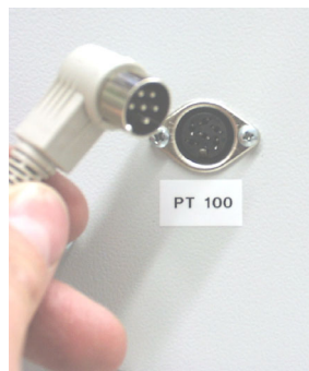
Рисунок 26: Подсоединение Pt100 (14) на задней стенке шкафа
