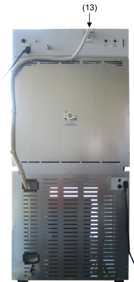
Рисунок 19: VD 53 с опцией “Вакуумный модуль”, смонтированный, со шлангом, подсоединенным к источнику вакуума
