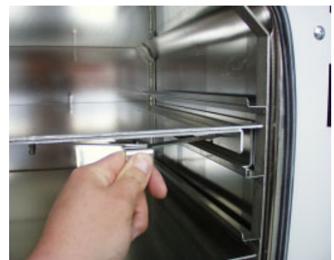
Рисунок 8: Применение распорок раздвижных полок
